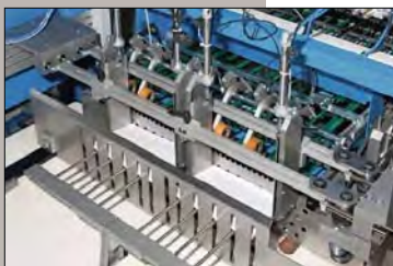
Stacking unit and multi-sided stacking alignment Unidad apiladora y centrado de pliegos apilados
